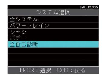
手順10. 全自己診断の実行 「全自己診断」が実行され、各コントロール ユニットのDTC(故障コード)の有無を 点検します。 終了するまで、暫くお待ち下さい。
