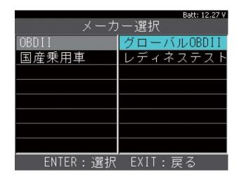
手順6. ECU選択 診断するECUの選択画面が表示され ますので、カーソルで選択して、本体の 「ENTER」を押して下さい。
