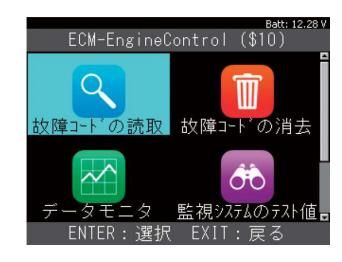
手順8. 故障コードの読取 コントロールユニットが故障コードを 記憶している場合は右図の様に 故障コードを表示します。 カーソルを故障コードに合わせて 本体の「ENTER」ボタンを押して 下さい。
