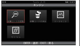
故障コードは番号(例: P030100)と内容(例: 失火検出#1)が表示されます。故障コードに選択カーソルを合わせて [ENTER] キーを押すと詳細表示に切り替わります。
