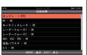
故障コードと内容を確認するには希望するシステムを選択して [ENTER] キーを押します。続いて「故障コードの読み取り」を選択して [ENTER] キーを押します。
