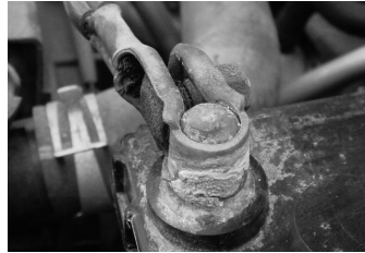
腐食したターミナル
