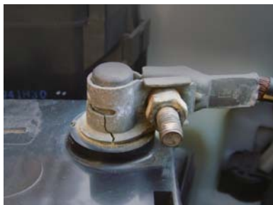
亀裂が入ったターミナル
