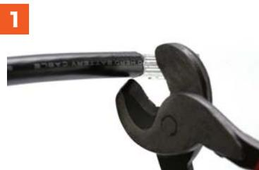
劣化したターミナルの電線と圧着された根元を切断して切断した電線の先端1cmほど被覆を剥いておきます。
