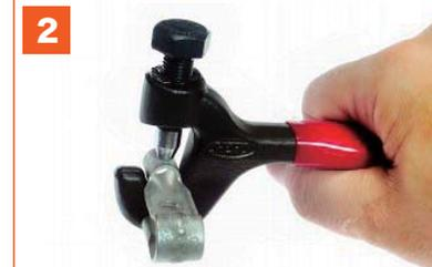
ターミナルをボルトの下に入れて挟み、ターミナルが動かないように手で軽く締め込み固定します。
