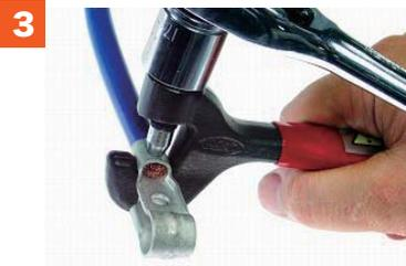
ターミナルに被覆を剥いた電線挿入し、ラチェットレンチでボルトを締め込んでいきます。
